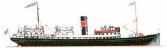
Belpareil (1926). Tungløfteskip f.eks. for frakt av lokomotiver mellom utelandske markeder
